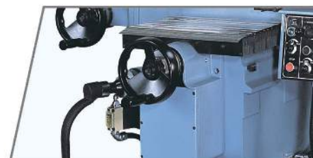
Y 軸馬達自動進給(選配) Y axis automatic feed
