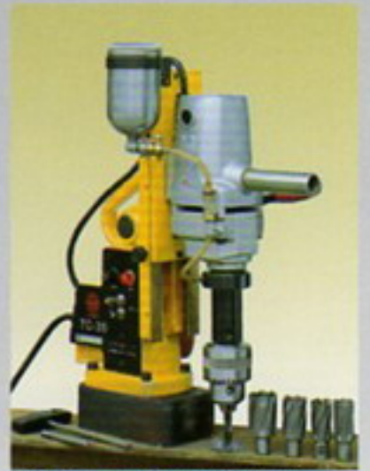
低啓動裝置，最適用於高硬度鋼材切割
