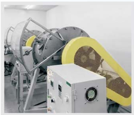
原料配製球磨機器設備
