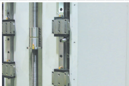
▲ 昇降採用精密級線性滑軌以及C3級滾珠導螺桿
