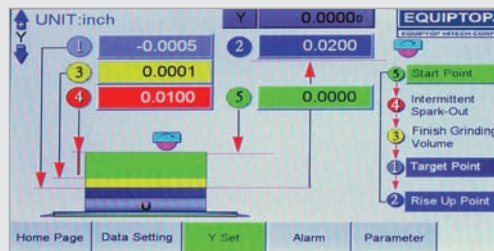
上下進給(可分粗磨、細磨、零研磨設定) 顯示最小單位:Y軸0.001mm / Z軸0.001mm
