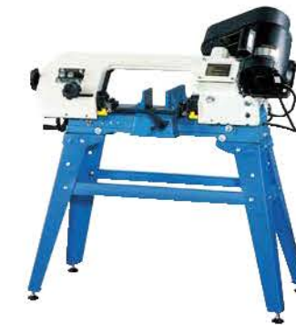
C-128 5" x 6" 立臥兩用帶鋸床 STEP PULLEY
