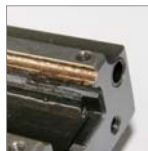
潤滑油乾涸殘留物 上儲油塊破損
