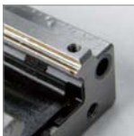
上儲油塊完好 供油正常 軌道面正常
