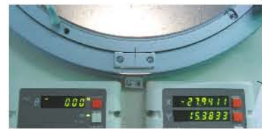
內建角度顯示器(V-12BDC和V-12BD)以及內建XY坐標顯示器(V-12BDC和V-12BSC)
