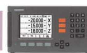
HEIDENHAIN ND-780用於MM-400S搭配台製CURIO系列8×4載物台
