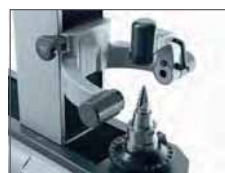
在鑽頭與銼刀的端面進行軸向的量測。
