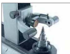
以實體影像攝影機量測刀具徑向的尺寸。
