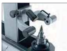
沿著垂直方向的任意位置進行倒角與圓弧的量測。
