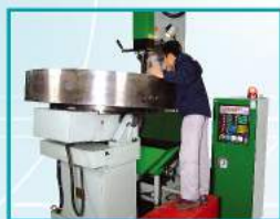
Φ1800mm 模具加工 MOLD IN EDM BEST-700
