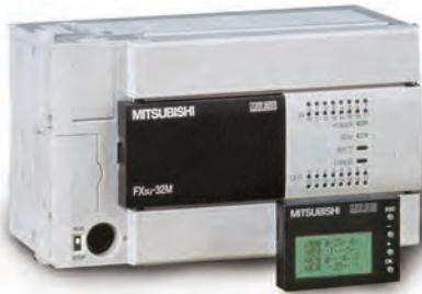
FX3U系列PLC IO點數:16點~128點 程式容量:64k steps 掃描速度:0.065us
