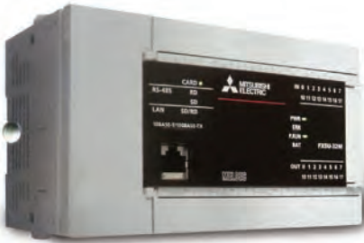
FX5U系列PLC IO點數:32點~80點 程式容量:64k steps 掃描速度:0.034us 內建 2A/D、1D/A
